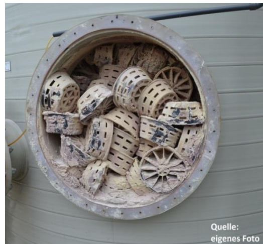
Bild 9: PP-Füllkörper mit abgesetztem festem Schwefel
