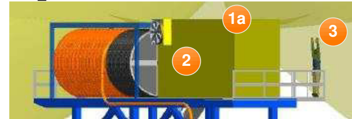
An2_Abb. 2: Kabeltrommel und E-Haus mit Klimaanlage
