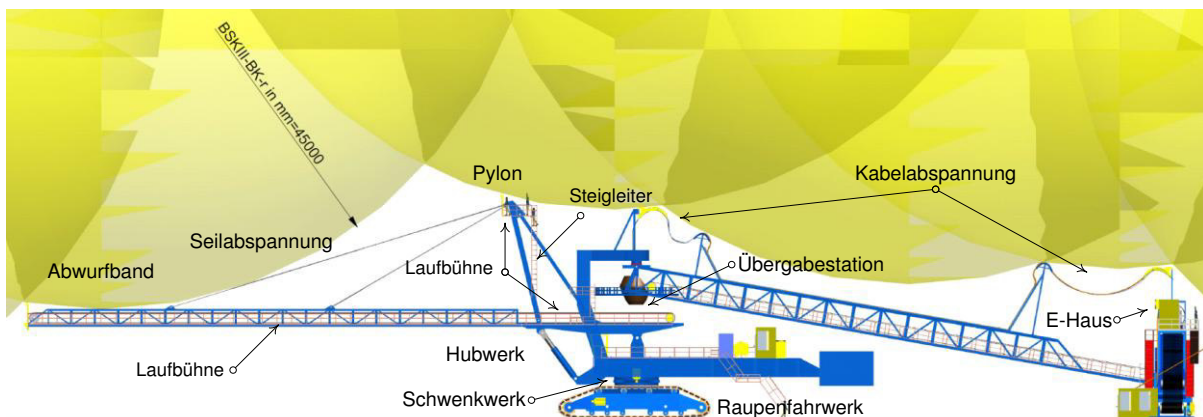
Abb. 10: Demonstration Blitzeinschlag am Absetzer
