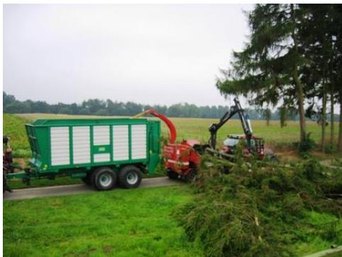
Abbildung 58: Holzhackschnitzelproduktion am Ort der Rodung
