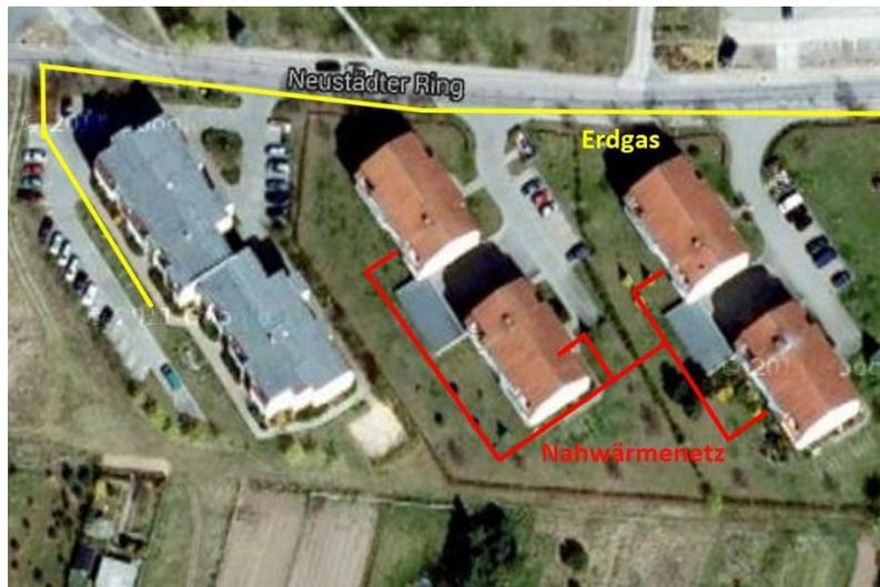
Abbildung 112: mögliches Nahwärmenetz und Erdgasleitung
