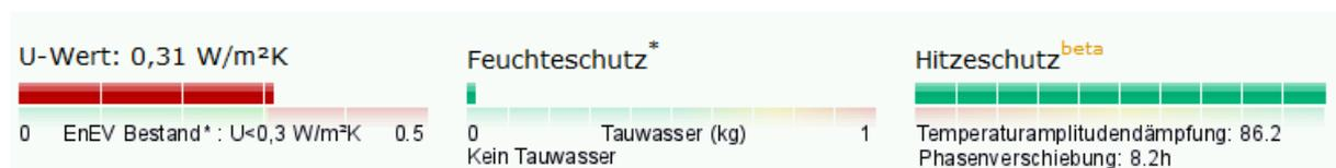
Abbildung 35: U-Wert, Feuchteschutz und Hitzeschutz der Kellerdecke
