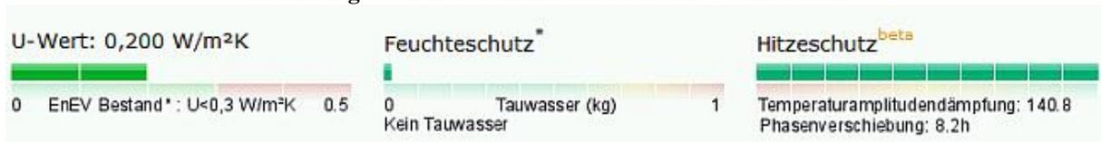
Abbildung 37: U-Wert, Feuchteschutz und Hitzeschutz der obersten Geschossdecke
