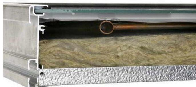
Der Absorber besteht aus einem geschwärtzten dünnen Metallblech, i.d.R. Kupferblech, an dem an der Unterseite dünne Kupferrohre befestigt sind. Das Metallblech sammelt die Wärme und gibt sie an die Rohre und dem darin befindlichen Wasser-Glykol-Gemisch weiter. Reines Wasser kann nicht als Medium eingesetzt werden. Denn der Kreislauf ist das ganze Jahr über befüllt und bei Außentemperaturen unter dem Gefrierpunkt droht durch das gefrierende Medium die Zerstörung des Kollektors.
