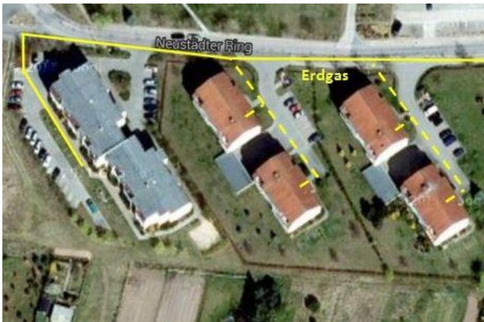
Abbildung 102: mögliche Verlegung der Erdgasleitungen für Variante A1
