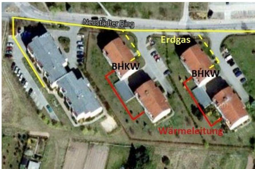
Abbildung 106: Leitungsverlegplan und BHKW-Standorte der Varianten B
