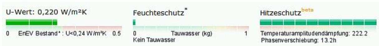
Abbildung 31: U-Wert, Feuchteschutz und Hitzeschutz der Außenwand
