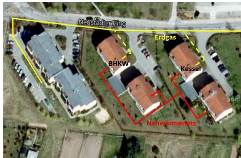
Abbildung 113: mögliches Nahwärmenetz und Wärmeerzeugerstandorte der Variante C1
