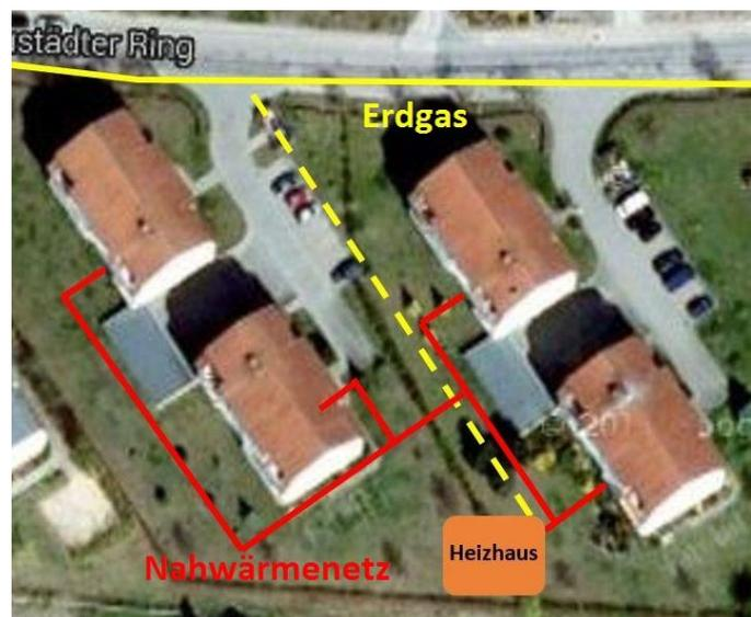
Abbildung 117: mögliche Verlegung eines Nahwärmenetzes und Standort eines Heizhauses
