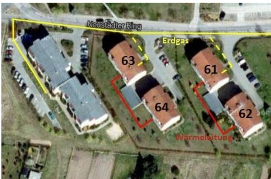
**Abbildung 104: mögliche Verlegung der Erdgas- und Wärmeleitungen für Variante A2**
