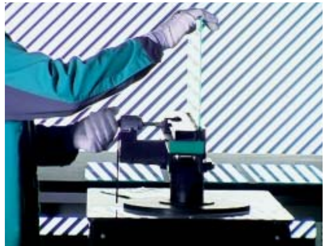
Im «Zebra test» wird die Planität (Verwerfung) stichprobenartig kontrolliert.
