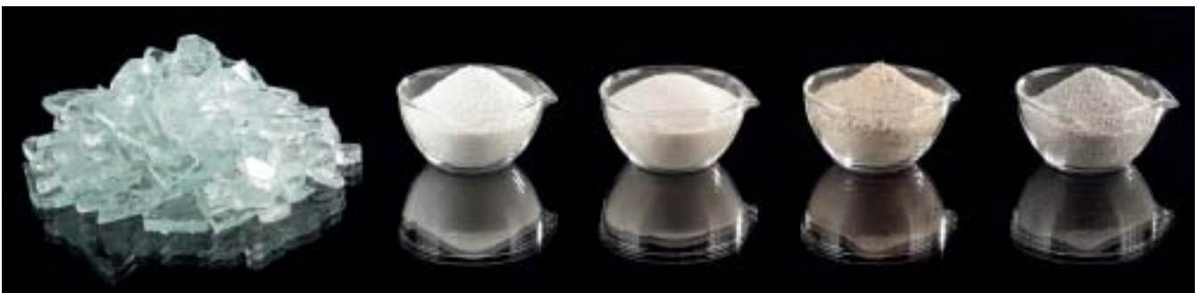
Rohmaterialien für die Floatglasproduktion (Scherben, Soda, Quarzsand, Kalk, Dolomit)
