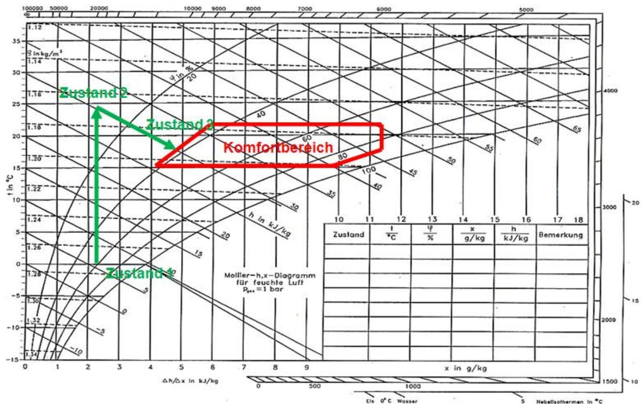
Abbildung 5 Beispiel Zustandsveränderung zum Komfortbereich im h, x-Diagramm
