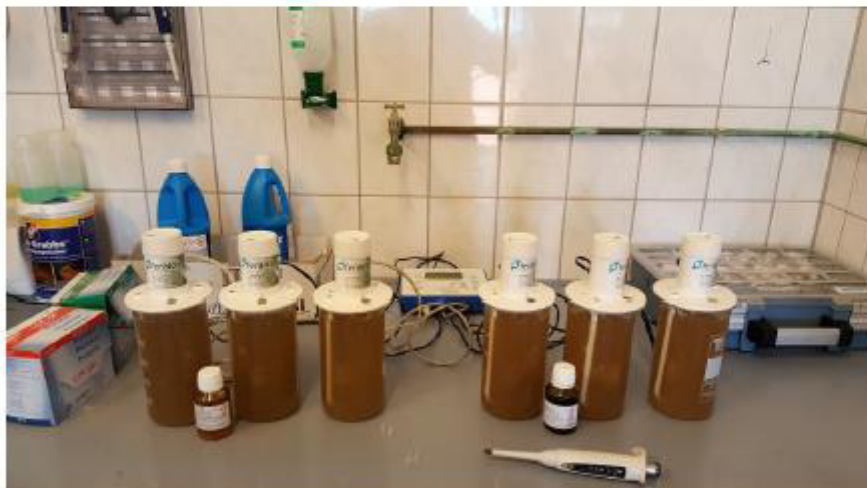
Abbildung 1: Versuchsaufbau Jar – Test, 6 x 1Liter Probe , Zugabe der Fällmittel in 3 Mengenabstufungen je Produkt
