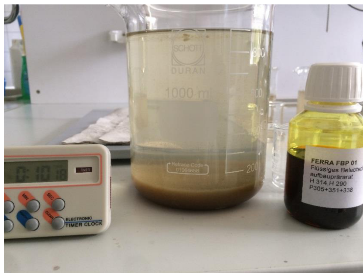
Abbildung 27 Selbst durchgeführter Jar-Test mit Belebtschlamm aufbaupräparaten [eigene Quelle: 2017]
