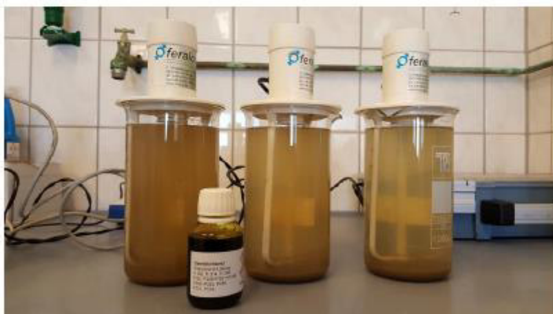
Abbildung 3: Sedimentierte Proben nach der Behandlung mit Eisen-(III)-Chlorid bei Dosierungen von 30, 60 und 90 µl/l v.l.n.r
