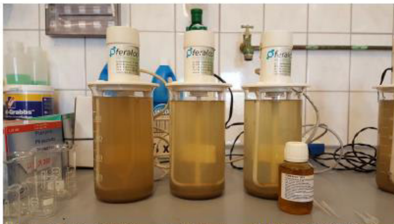
Abbildung 2: Sedimentierte Proben nach der Behandlung mit FERRAPAC 1625 bei Dosierungen von 30, 60 und 90 µl/l v.l.n.r
