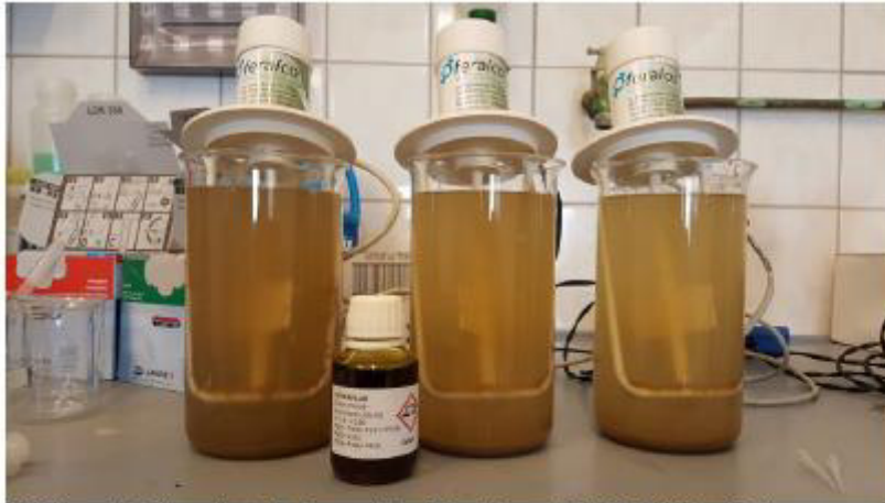
Abbildung 4: Sedimentierte Proben nach der Behandlung mit FERRAPLUS bei Dosierungen von 30, 60 und 90 µl/l.v.l.n.r
