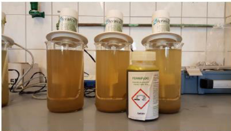
Abbildung 5: Sedimentierte Proben nach der Behandlung mit FERRIFLOC bei Dosierungen von 30, 60 und 90 µl/l.v.l.n.r
