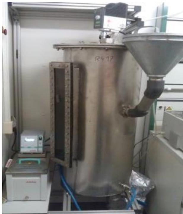
Abb. 4.1 Der Lagerungsreaktor im Containerlabor
