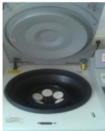
die eingewogenen Flaschen in die Zentrifuge setzen
