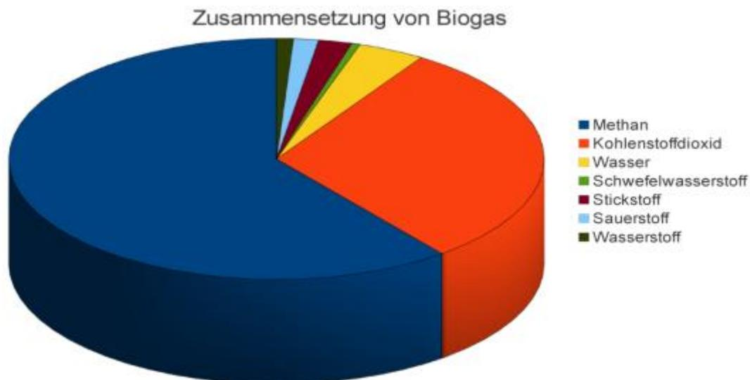
Abb. 3.2 Durchschnittliche Zusammensetzung von Biogas [3]
