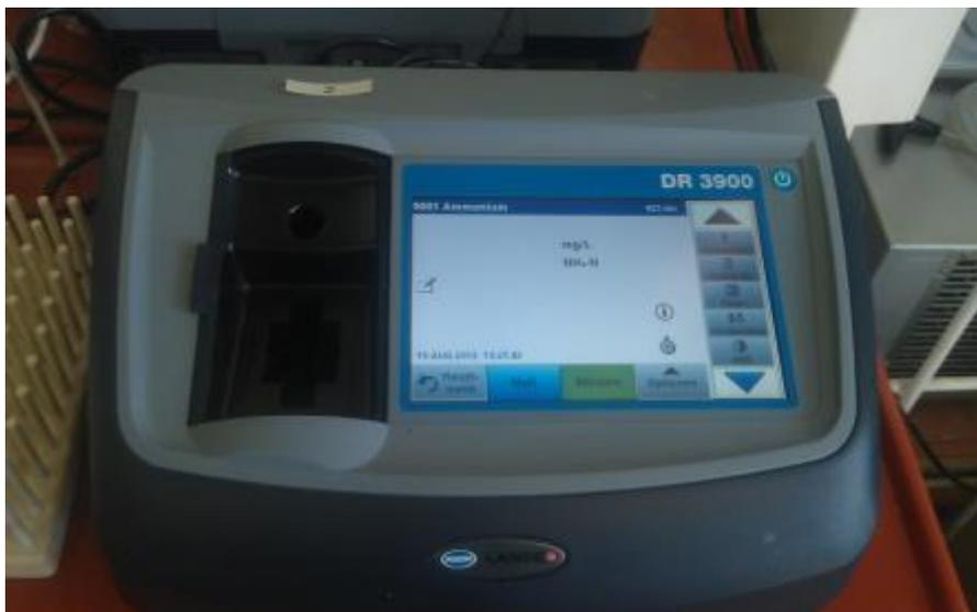
Abb. 4.15das Photospektrometer
