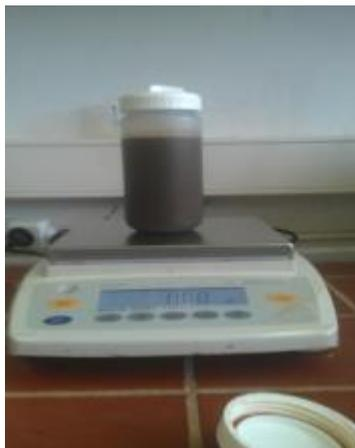
Impfschlamm in den Zentrifugierungsflaschen wiegen
