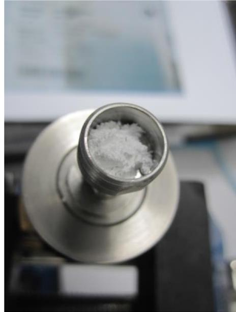
**ABBILDUNG 8 RESERVOIR BEFÜLLT MIT KUGELN UND PARTIKELN**
