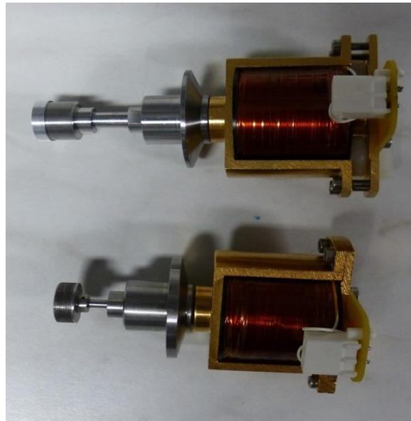
ABBILDUNG 65 VERGLEICH ZWISCHEN URSPRÜNGLICHEN UND ANGEPASTEN DISPENSOR
