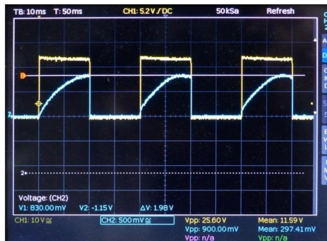
ABBILDUNG 75 VERSUCH MIT 40MS/20MS UND NACHGERÜSTETER DIODE
