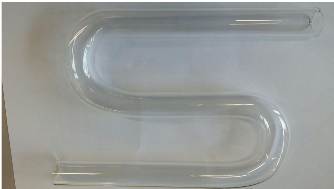
Abbildung 5-17 Nach Skizze hergestellter Siphon
