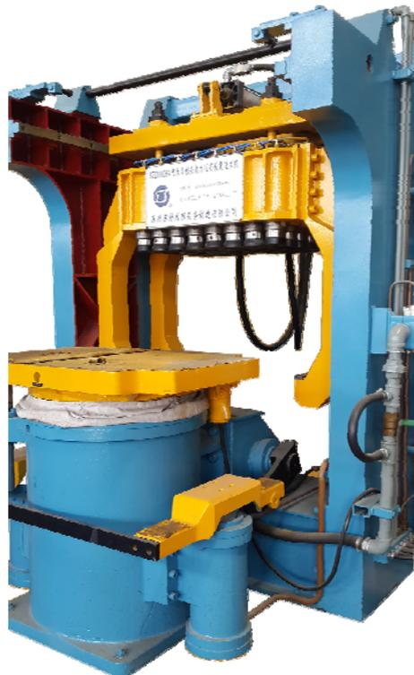
Abb. 9 Rüttel-Press-Formmaschine<sup>[4]</sup>
