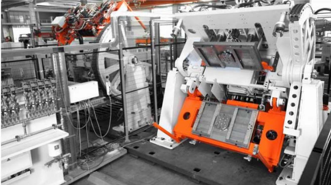
Abb.14 Kokillengießmaschinen von KUKA<sup>[7]</sup>
