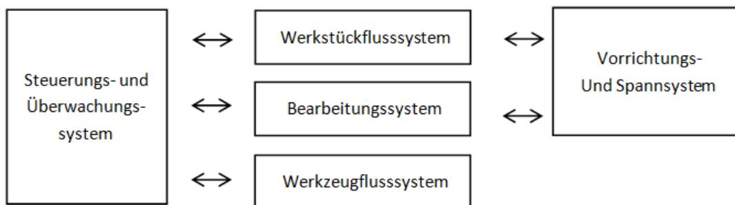
(Abb. 2: Elemente eines FFS und deren Wechselwirkungen)<sup>[3]</sup>
