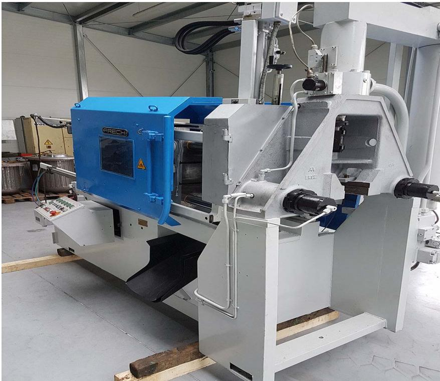
Abb.17: Warmkammergießmaschine von Frech<sup>[5]</sup>
