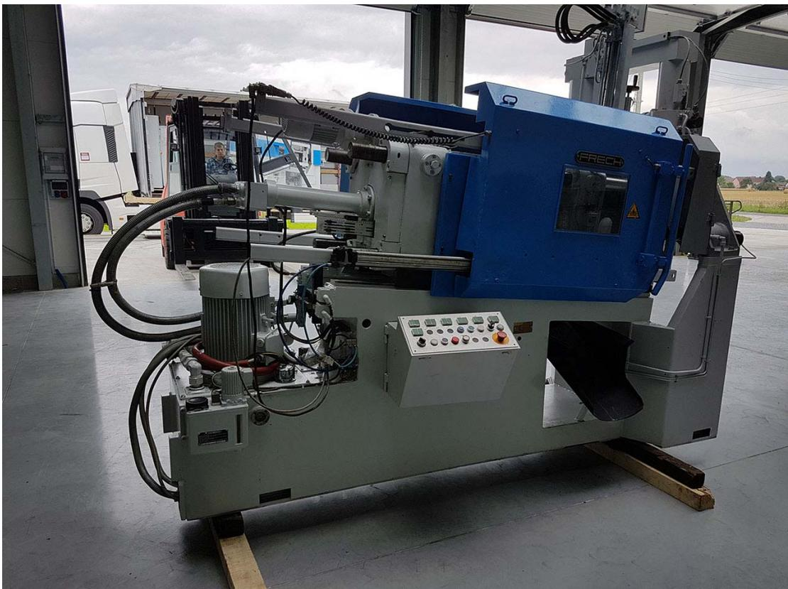
Abb. 12 Warmkammergießmaschine von Frech<sup>[5]</sup>
