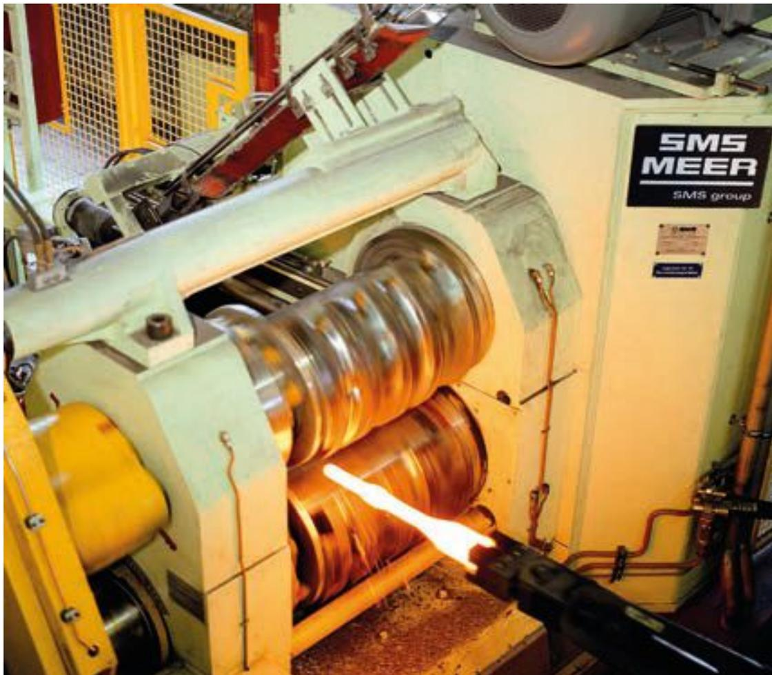
(Abb.28 Einführung eines Rohteils zu dem Walzspalt )
