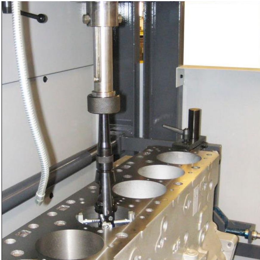
Abb. 19: Vertikal – Honmaschine (Zylinderlaufbuchsen bearbeiten) [11]
