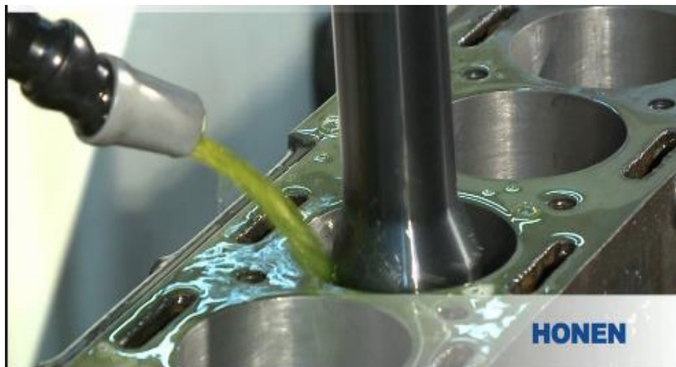
Abb. 25: Bearbeitung mit CNC – Honmaschine [12]
