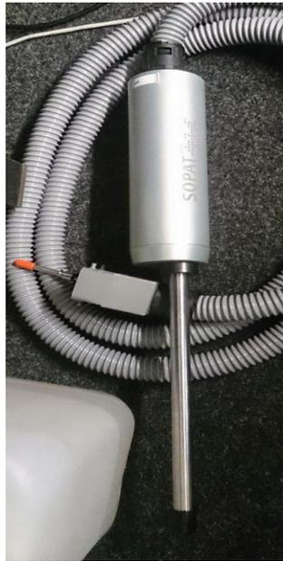
Abb. 5: Sopat-Sonde vor dem Einbau
