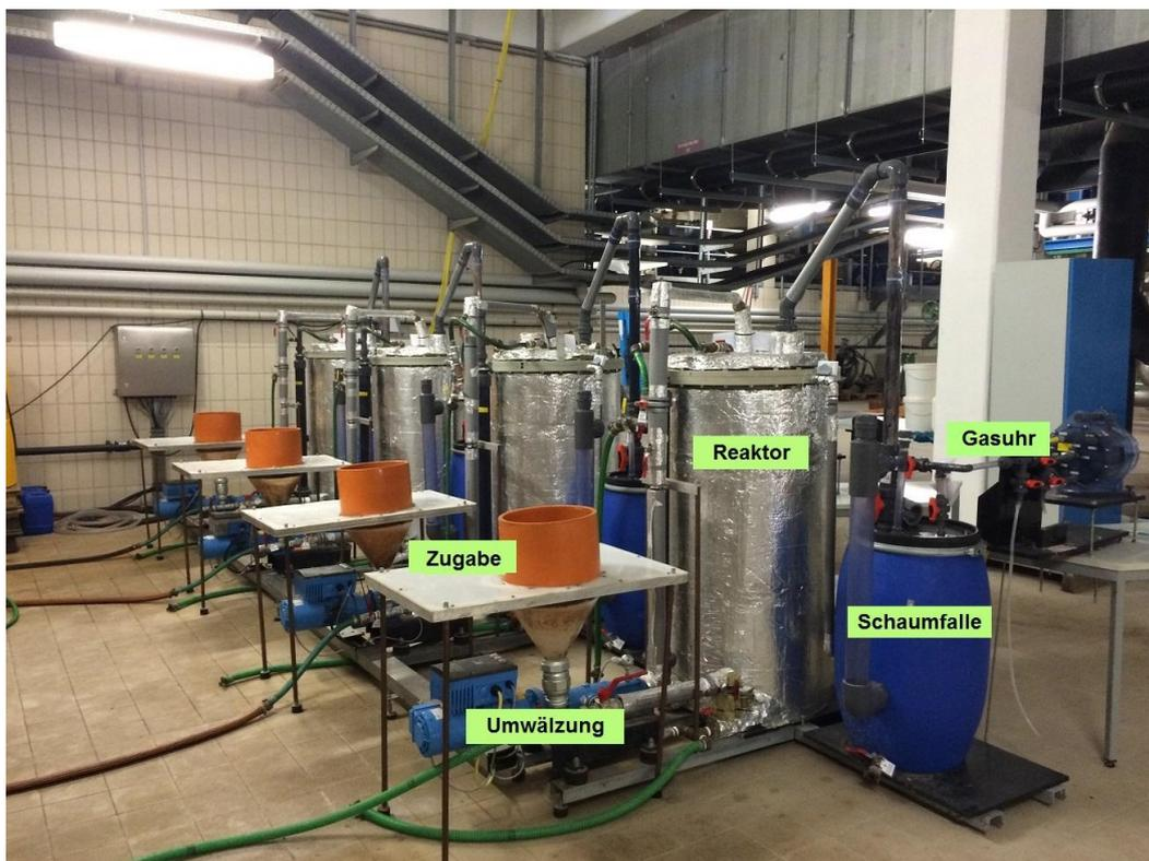
**Abb. 3: Aufbau der Versuchsanlage**
