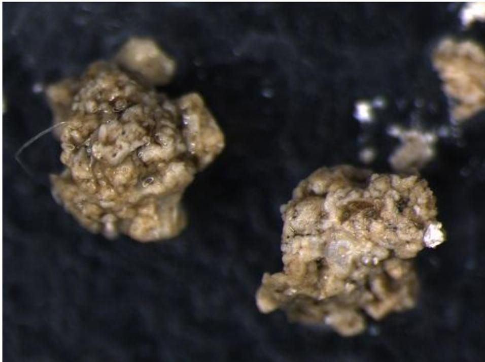
**Abb. 27: Aggregate bei 20-facher Vergrößerung**
