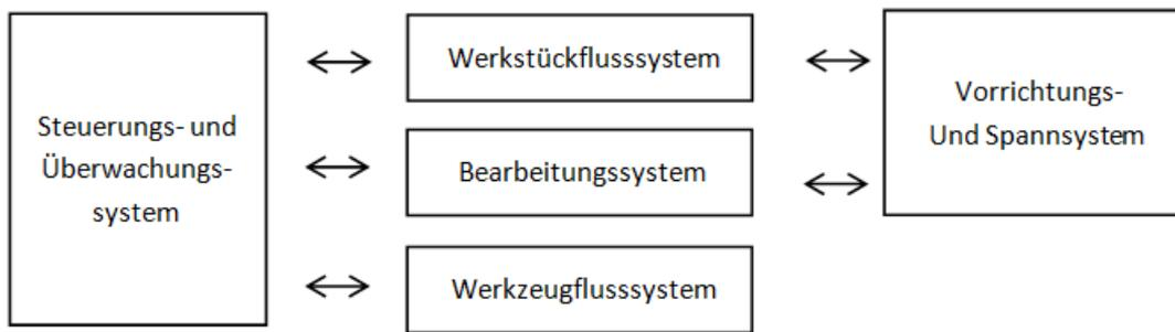
Abb. 2- Elemente eines FFS und deren Wechselwirkungen <sup>[1]</sup>
