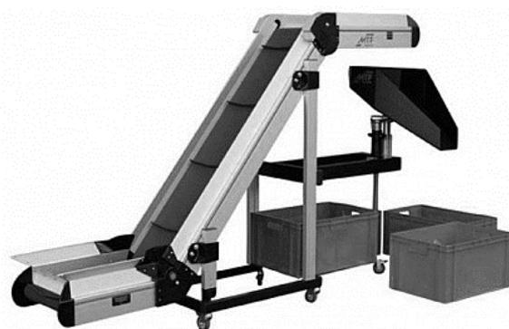
Abb. 43- Transportmittel für Roh-/Fertigteile <sup>[10]</sup>
