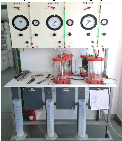
Abbildung 8: Versuch in der Triaxialzelle mit isotroper statische Belastung
