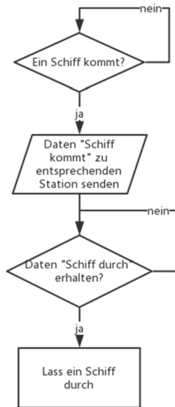
Abb. 42 Funktionsablauf von Stopper1 / Stopper2
