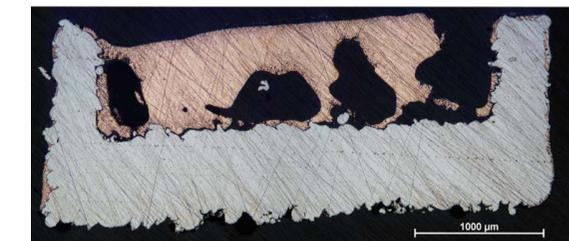
Dicke der Cu-Schicht: 750 µm
