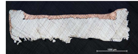
Dicke der Cu-Schicht: 250 µm
