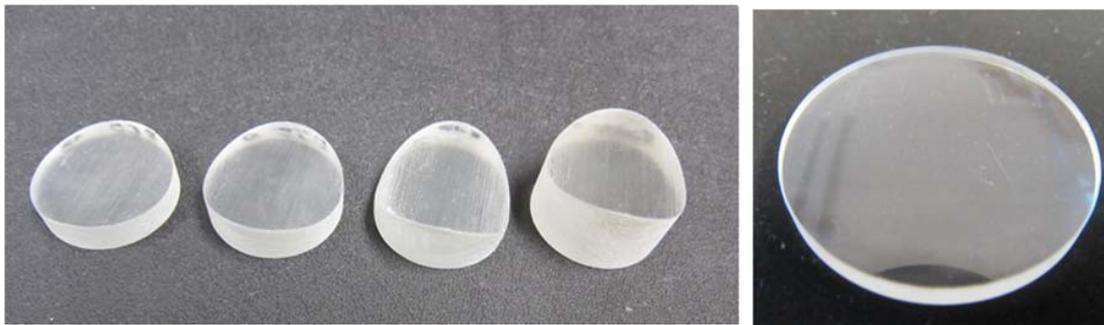
a) **Abb. 6:** Additiv gefertigte optische Bauelemente. a) nach dem Druckprozess, b) nach dem Polierprozess
