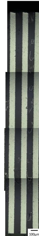
zusammengesetzte Querschliffbilder einer 80  $\mu\text{m}$  dünnen Mikrowand mit einer Höhe von ca. 10 mm, gleichmäßige Verteilung der Mikroporen →
