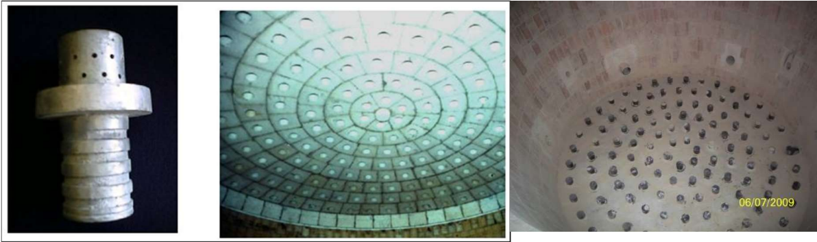
Abbildung 5: Links: einzelne Düse, Mitte: Düsenboden von der Windbox aus /10, S. 29/, rechts: Düsenboden von oben /11/
