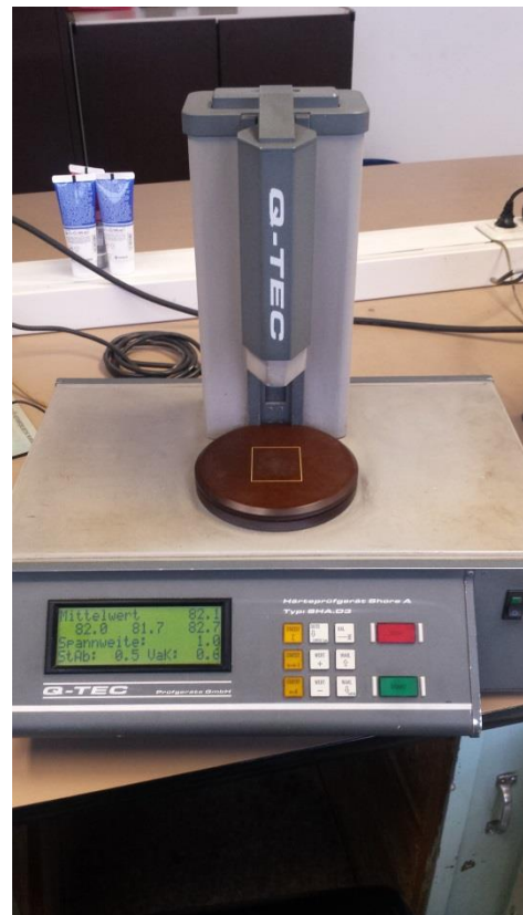
Bild 3.3.1: Gerät zur Härtemessung SHA.D3
