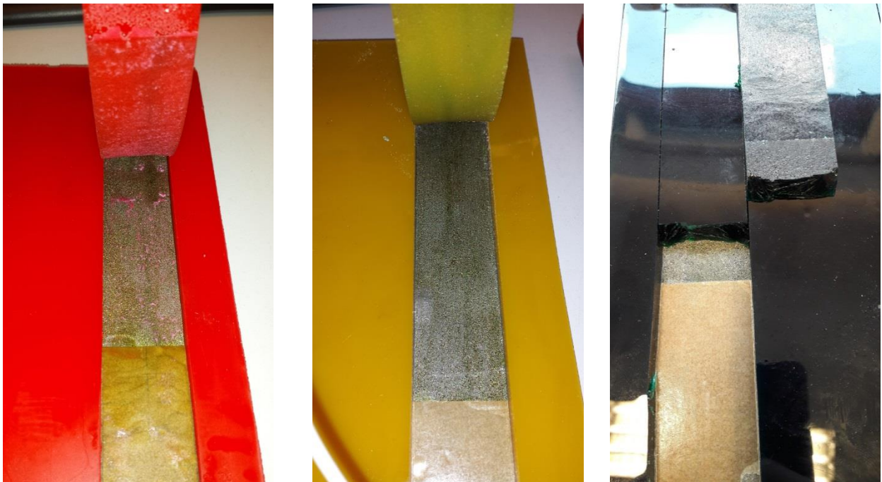
Bild 4.3.1: Haftfestigkeit geprüft (1960/5960) ; G Probe 1 (links); AU Probe 3 (mitte); EU 8h Probe 1 (rechts)
