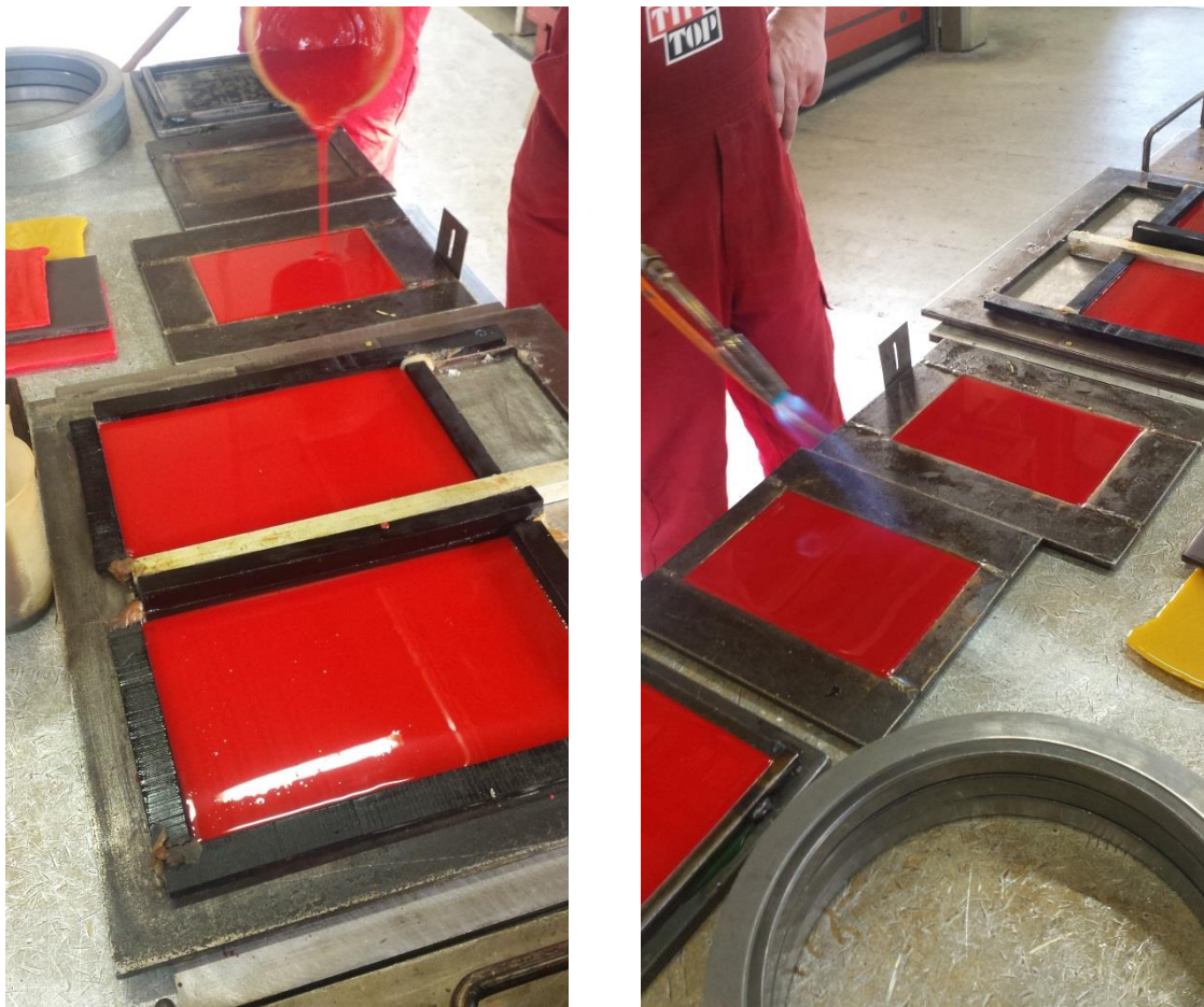
Bild 3.2.1: Gießvorgang, leichte Blasenbildung (untere Form) (links); Auflösen der Bläschen durch Brenner (rechts)
