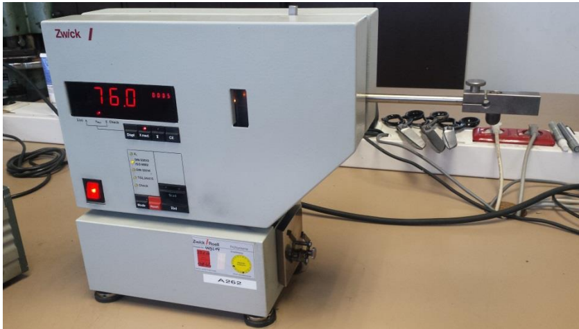
Bild 3.3.4: Gerät zur Messung der Rückprallelastizität
