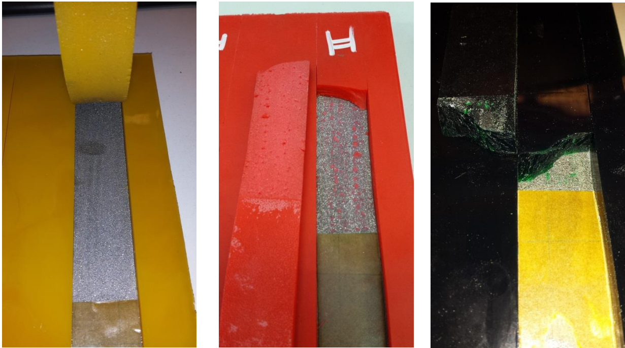
Bild 4.3.2: Haftfestigkeit geprüft (Cilbond); G Probe 2 (links); AU Probe 2 (mitte); EU 12h Probe 4 (rechts)
