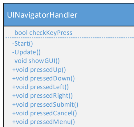
Abbildung 14: Klassendiagramm für das Eingabesystem
