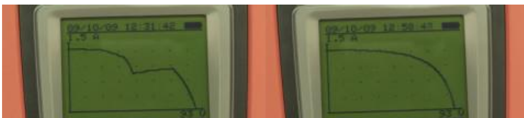
Abb. 15: Abweichung der Kennlinie verursacht durch punktuellen Zellen defekt und defekter Bypassdiode Quelle: Eigene Darstellung
