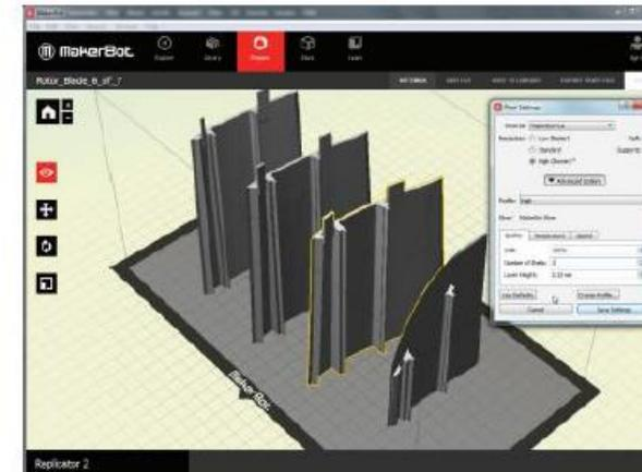
Vorbereitung der Druckdatei der Rotorblattsegmente in der kostenlosen MakerBot Desktop Software
