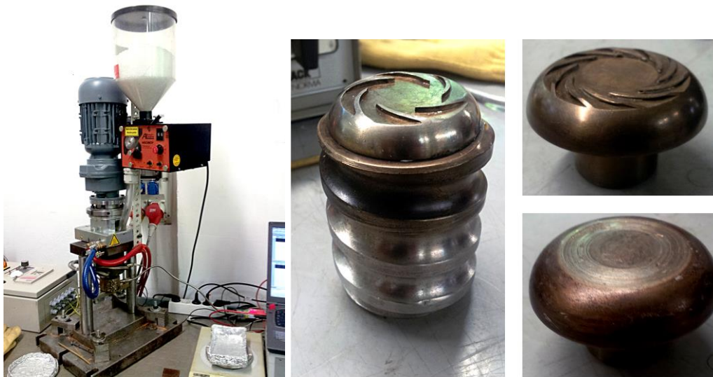
Abb. 1: Versuchsvorrichtung zu Scheibenplastifizierung. Rechts die vertikale Kompletanlage, Mitte: Plastifizierrotor mit Spiralscheibe, rechts: Scheibengeometrien „glatte Scheibe“ (unten) und „Spiralscheibe mit 10 Kammern“ (oben).
