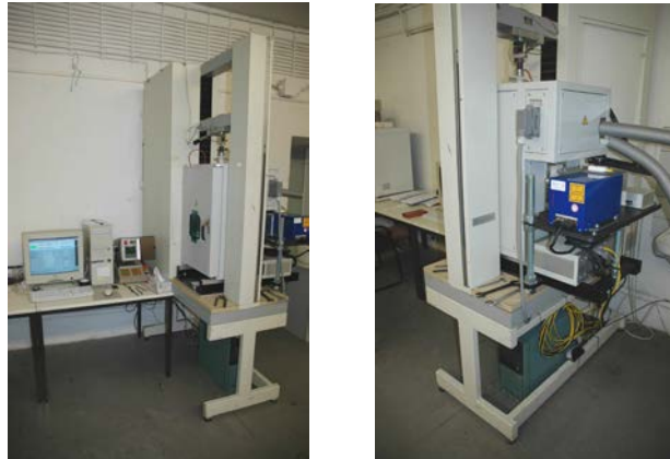
Bild 1: Parallels Scanner-Laserextensometer zur temperaturabhängigen Untersuchung des lokalen Deformationsverhaltens (Vorder- und Rückansicht)
