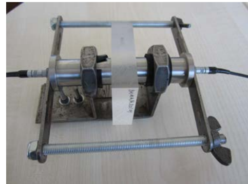
Bild 2: Versuchsaufbau zur Messung der akustischen Materialeigenschaften
