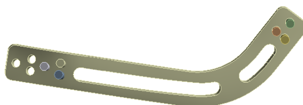
Bild 7: Langlochdesign; Befestigung mit drei Bolzen
