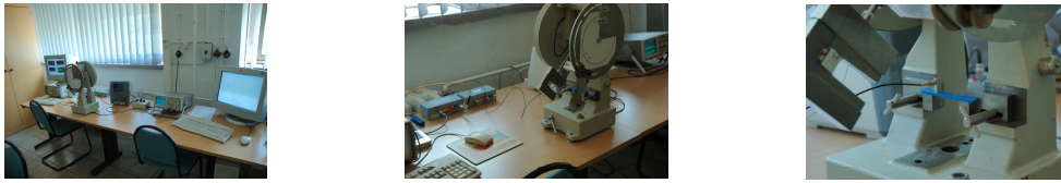
Bild 1. Messplatz zur Durchführung des instrumentierten Kerbschlagbiegeversuchs mit Aufzeichnung der Schallemissionen
