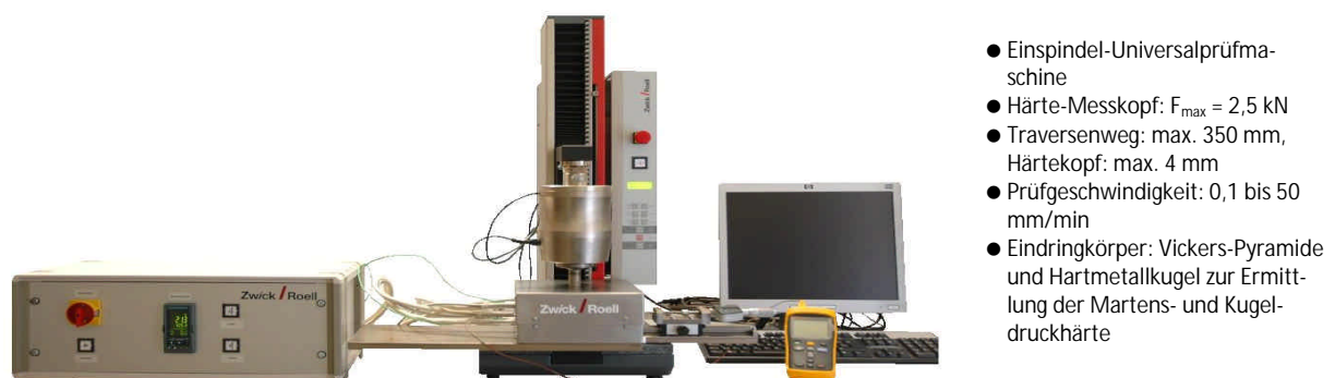
Bild 3: Makrohärteprüfgerät Zwicki ZHU 2.5 mit Temperierkammer (rechts) und Temperaturregelungseinheit (links) inkl. der technischen Parameter
