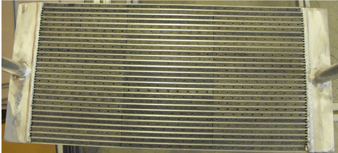
Abbildung 19: Bild eines mit Fasern versehenen Aluminiumwärmeübertrages (Quelle: SorTech AG)
