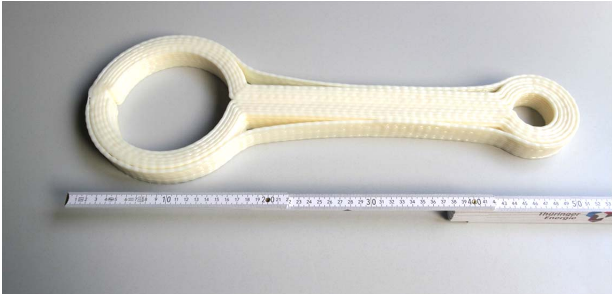
Abbildung 3: FDM-Teil im 2 ½ D-Verfahren hergestellt
