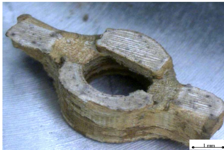
Miniaturgreifarm - Abriss bei Bauhöhe 2,1 mm von 7 mm
