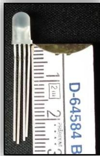
Abbildung 054 - Länge der Anode und Kathoden der angewandten RGB-LED
