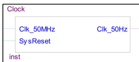
Abbildung 105 - Blockschaltbild eines 50Hz-Takteilers
