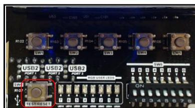
Abbildung 119 - Test/Reset-Taster des NB3K
