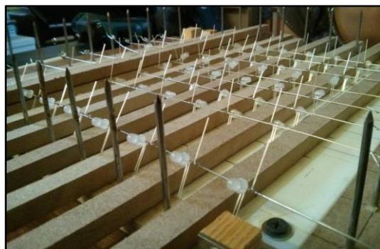
**Abbildung 061 - Lötens von Anoden in einer Reihe**
