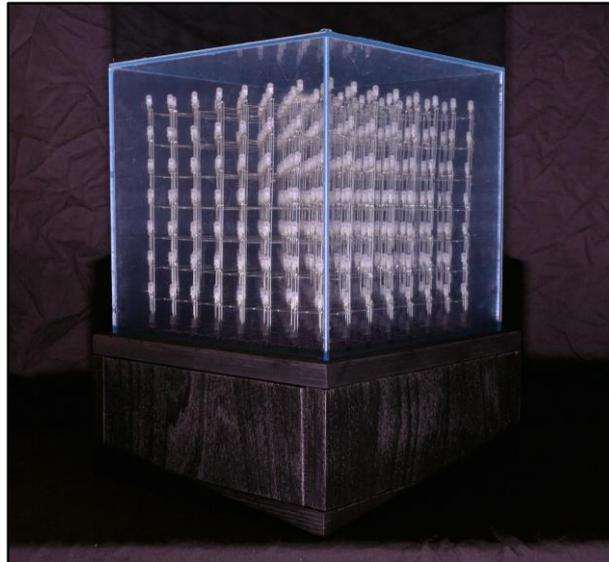
Abbildung 070 - Fertiger RGB-LED-Cube auf einem Holzgehäuse
