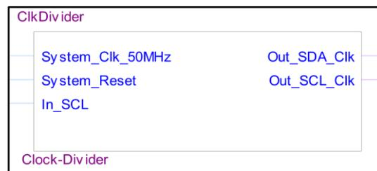
Abbildung 132 - Blockschaltbild eines I<sup>2</sup>C-SDA- und SCL-Taktteilers im Quartus II
