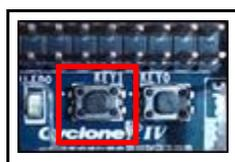
Abbildung 103 - Reset-Button Altera DE0 NanoBoard
