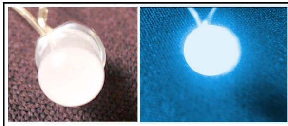
Abbildung 118 - Verifikation eines 1Hz-Takteilers am NB3K an einer LED
