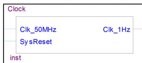
Abbildung 112 - Blockschaltbild eines 1Hz-Takteilers im Quartus II
