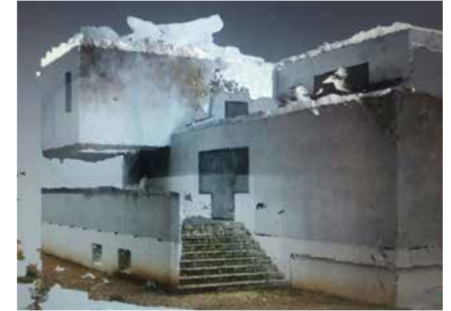
Photogrammetrischen Objektaufnahme Zwischenstand der Punktwolke mit Textur.
