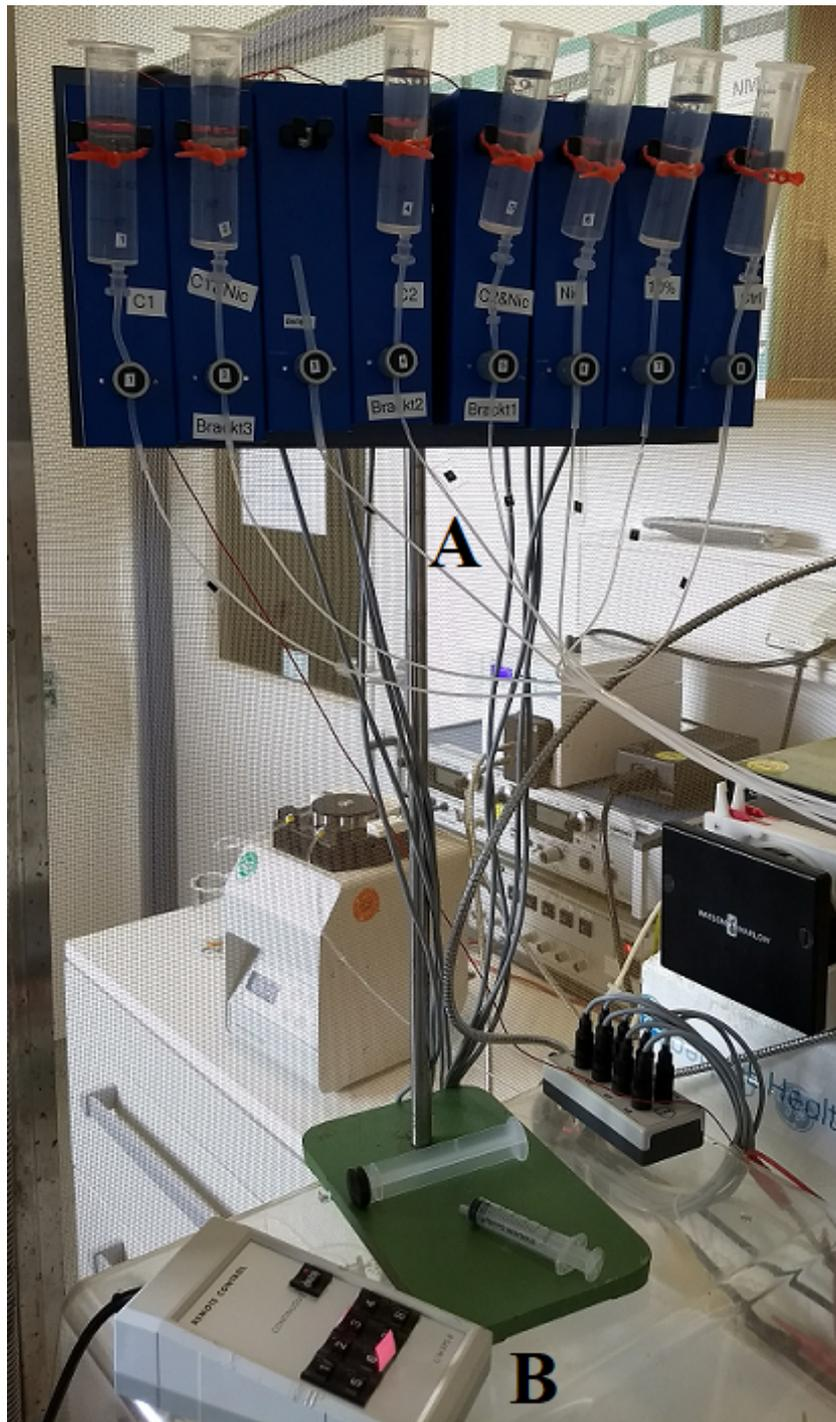
Abbildung 16: Verwendet Perfusionssystem. (A) Vorratsgefäße in Form von Spritzen, (B) Steuerungseinheit
