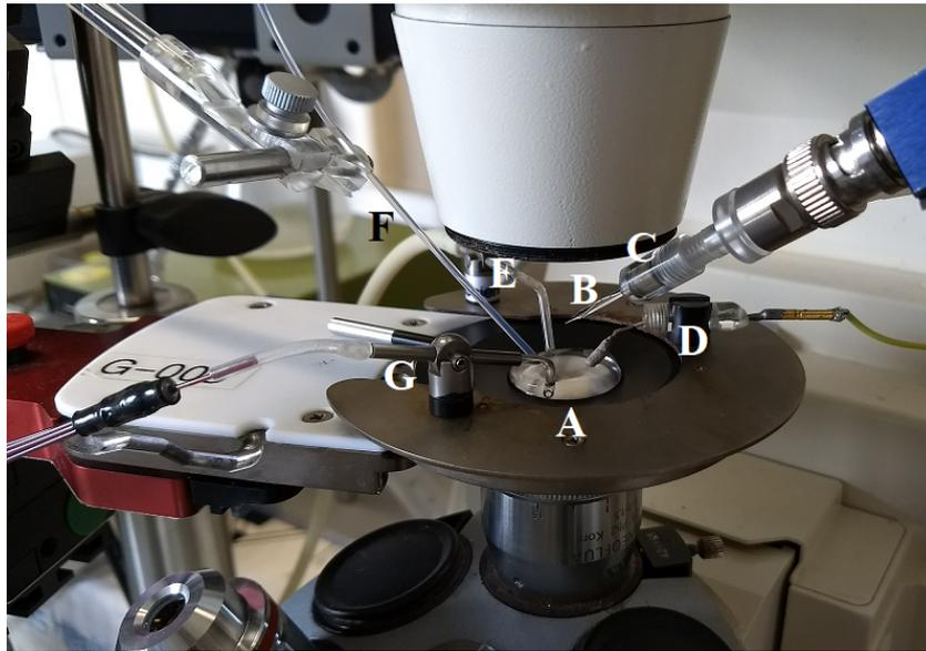
Abbildung 14: Messkammer des manuellen Patch Clamp Aufbaus.
