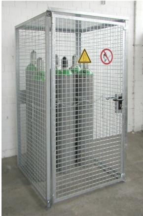
Abbildung 32: Beispiel Druckgasflaschen in Käfig
