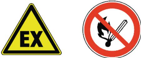
Abbildung 31: Kennzeichnung explosionsgefährdeter Bereiche
