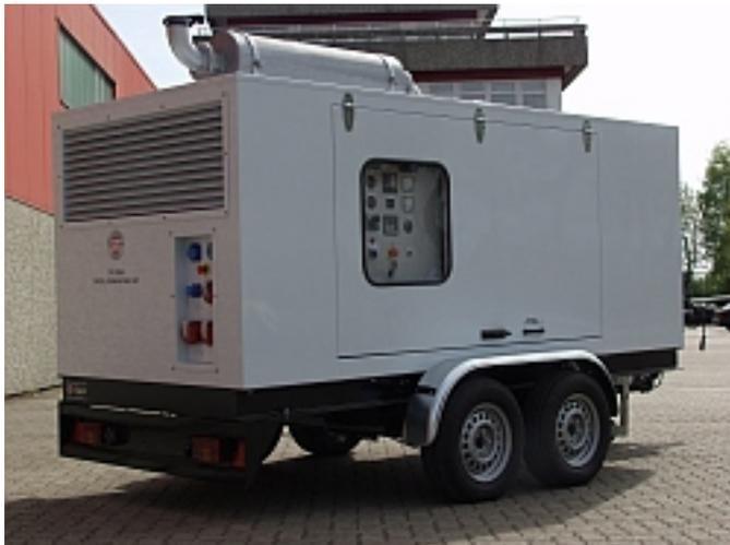
Abbildung 24: Aggregat auf Tandemanhänger
