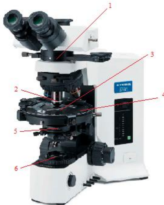
Abbildung 11: Foto des genutzten Mikroskops Olympus Serie BX51 mit Nomenklatur
