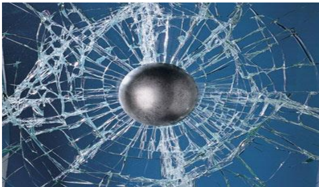
Abb. 2-5: Das Verbundsicherheitsglas beim Bruch [11]
