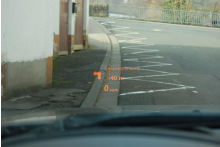
Abb. 5-7: Die Windschutzscheiben mit HuD-System [16]
