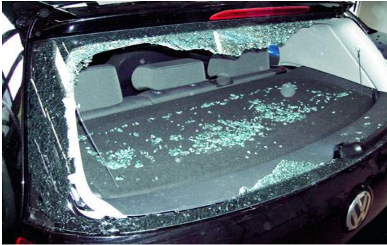
Abb. 2-2: Das Einscheibensicherheitsglas beim Bruch [9]
