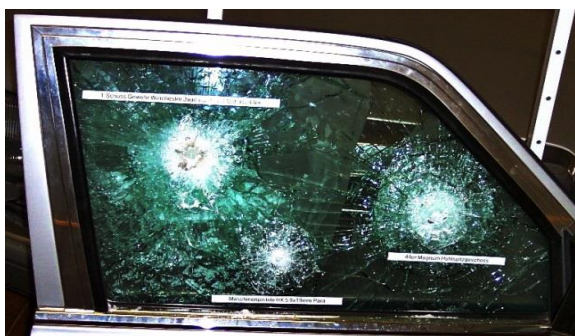
Abb. 2-6: Beispiel für das Panzerglas [12]
