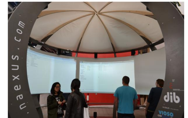
Das „NAEXUS-Virtual Space Scope“ hat einer Höhe von vier Meter und einen Durchmesser von sechs Meter. Die Projektionsoberfläche im Inneren wurde Anfang 2013 erneuert und ist nun in der Horizontalen sowie in der Vertikalen gekrümmt. Über 4 Baemer und eine Pixelverzerrungssoftware wird die Bedienoberfläche auf die Leinwand projiziert.
