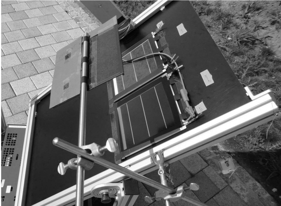
Anhang A: Aufbau zur Bestimmung der Diffusstrahlung durch Abschattung des Solarmoduls
