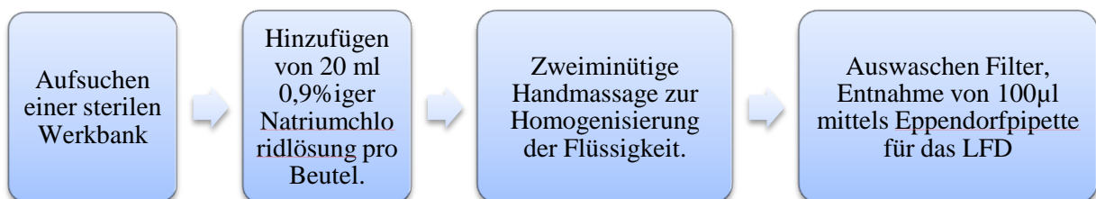
Abbildung 16 : Probenpräparation der PassPork-Methode mit integriertem Filter im Stomacherbeutel
