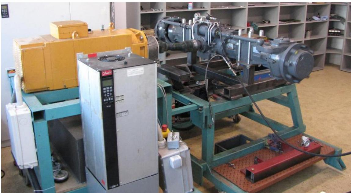
**Abb. 12: Achsprüfstand**
