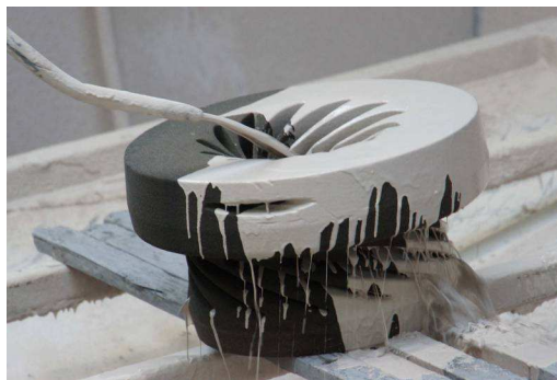
Abb. 30: Foto eines Sandkerns, wie er mittels Direct Curing erzeugt werden kann; dieser wird hier mit Schichten überzogen [VO14]
