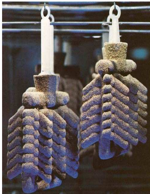
Abb. 2: Foto einer mit Schlicker beschichteten Traube zum Feingießen [MK14]
