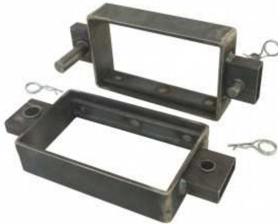
Abb. 20: Zweiteiliger Formkasten mit Verbindungselementen [AS14]
