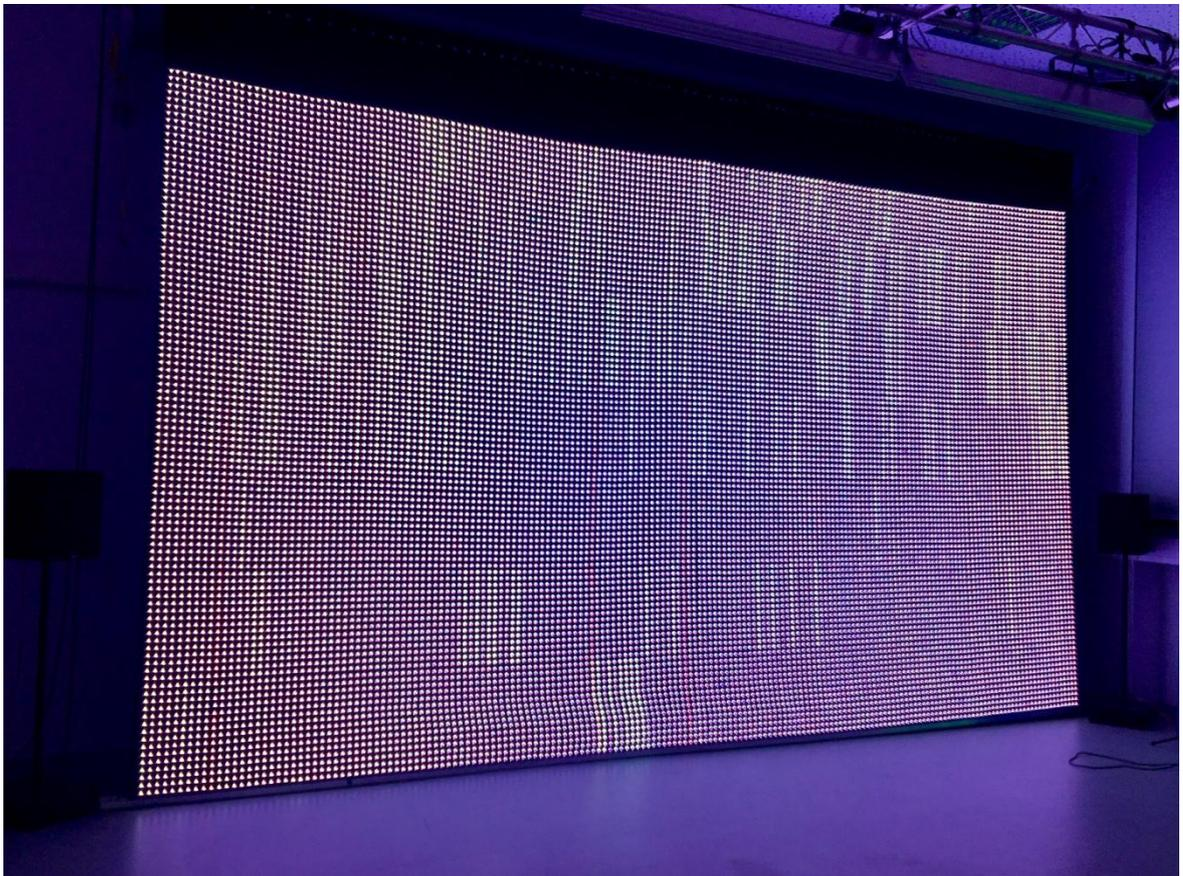
Abbildung 1: LED Wand als Hintergrundstrahler, einfarbig leuchtend [HK17]
