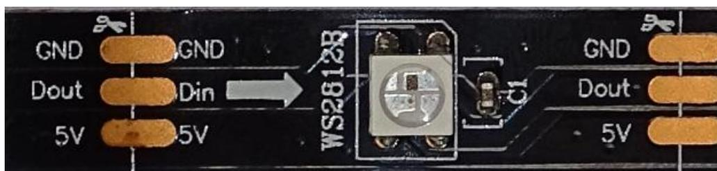
Abbildung 7: Einzelne WS2812B LED auf einem Strip [HK17]
