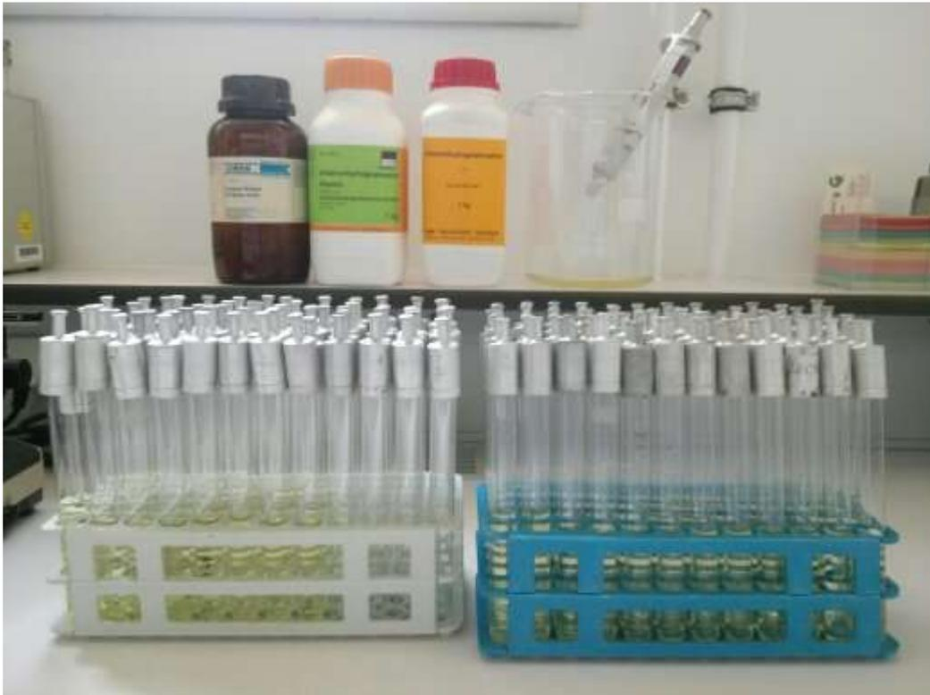
Abb.11 : vorbereitete sterilisierte Pufferlösung
