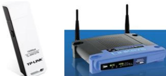
Abbildung 3.1 : USB drahtloser Adapter und drahtloser Router
