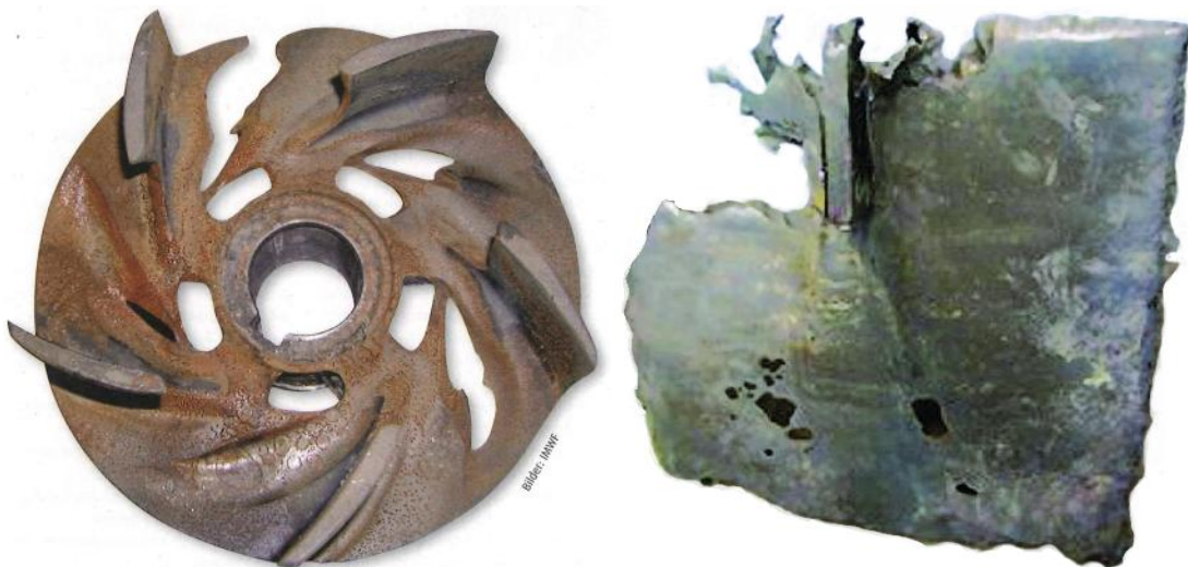
Abbildung 1-1: Schäden durch Hydroabrasion an einem Pumpenlaufrad [1] und einem Rührer [2]
