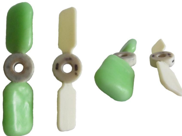
Abbildung 4-2: Mit Wachs beschichteter und unbeschichteter Rührer
