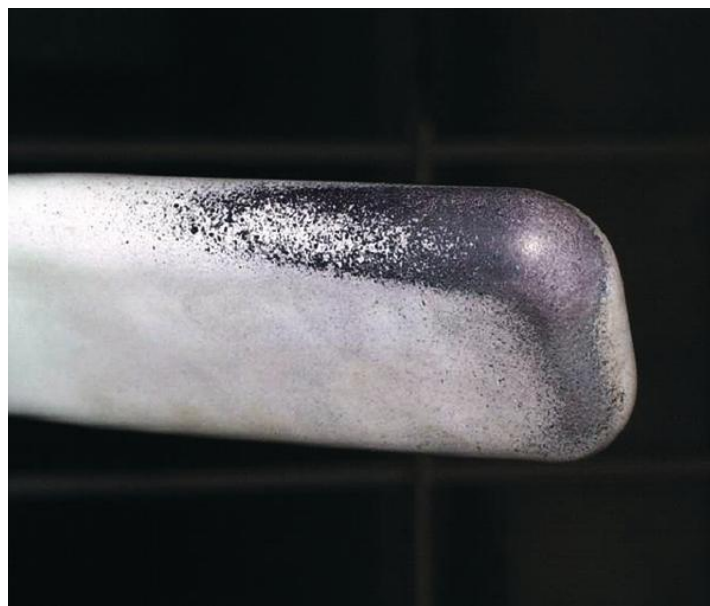
Abbildung 3-7: Schadensbild eines emaillierten Rührerblattes infolge von Abrasion [18]
