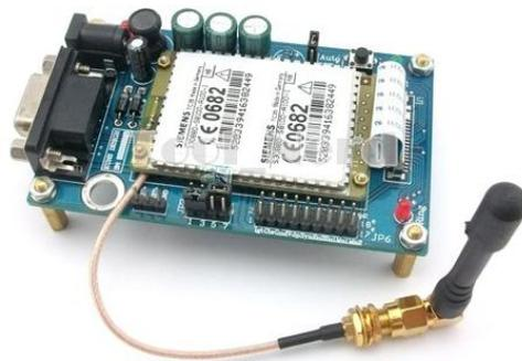
Abbildung 2.4: GSM-Modem TC35i mit RS-232 Schnittstellen
