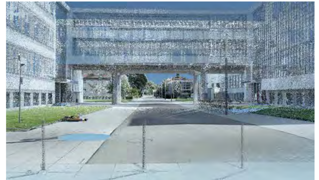
Bei der Erstellung des 3D-Modells des Bauhausgebäudes wurde das Objekt von außen nach innen aufgemessen, modelliert und in einer Punktwolke zusammengeführt.
