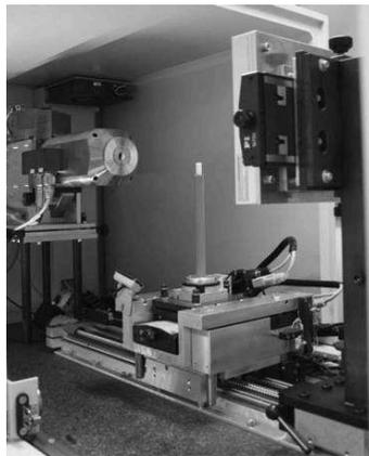
**Abbildung 3.8:** Messkammer mit Röntgenquelle und Detektor des Röntgenmikrotomographen (Dadkhah et al., 2012)
