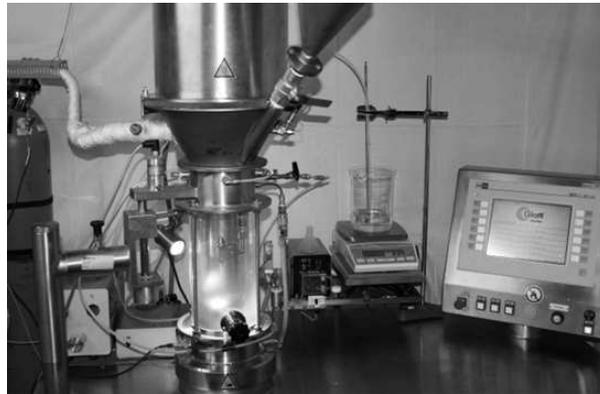
**Abbildung 3.2:** Prozessraum der modifizierten Laborgranulationsanlage WSA150
