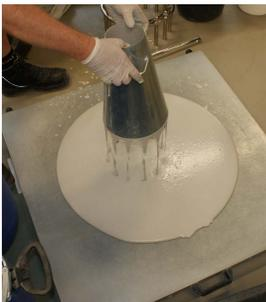
**Abb. 5.7:** Versuchsaufbau Setzfließmaß
