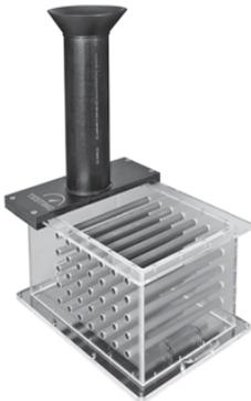
**Abb. 5.10:** Konventioneller Kajima-Box-Test zur Bestimmung des Füllgrades von Beton gemäß dem Entwurf der DAfStb-Richtlinie „Selbstverdichtender Beton“ [51]
