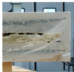
Abb. D.4.1: Ergebniss zum Biegezugfestigkeitsversuch der Klebefuge - mit: *links*: zu prüfender Probekörper; *mitte*: Rissbild in der Draufsicht; *rechts*: Rissbild im Schnitt;
