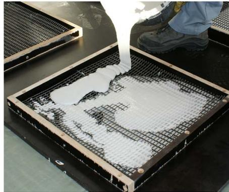
**Abb. 5.11:** Modifizierter Kajima-Box-Test zur Bestimmung des Füllgrades von Beton gemäß der Zielstellung eines selbstständigen Umschließens von Textil- und/oder Carbonfaserbewehrung
