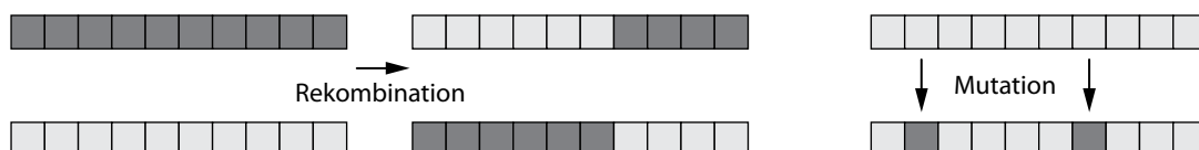
Abbildung 2.25: Funktionsweise der genetischen Operatoren Rekombination und Mutation, nach [GKK04]
