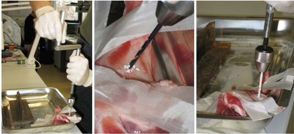
Abbildung 28: Performanztest des Keramikbohrers im Vergleich mit einem Standard-HSS-Bohrer am Schweineknochen
