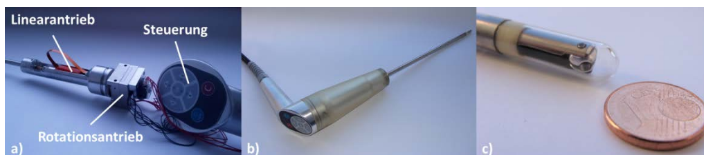
Abbildung 36: Finaler Prototyp des Endoskops mit bewegbarer Kamera: a) Antriebs- und Steuerungsmodul b) Griffstück mit sterilisierbarer wechselbarer Außenhülle, c) Endoskopspitze (erstellt durch InKraft GmbH)
