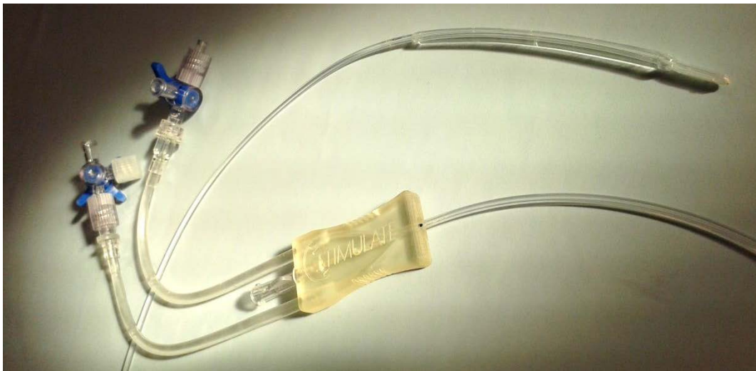
Abbildung 40: Demonstrator des Kühlkatheters mit Anschluss für Vor- und Rücklauf sowie Arbeitskanal in der Mitte
