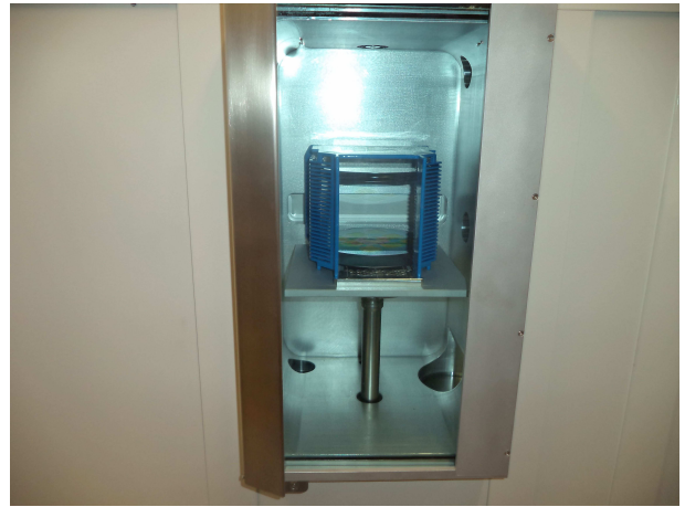
(d) Multiple wafer cassette inside loadlock
