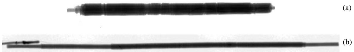
Abb. 6.4 Verwendete Empfangsspulen der Firma Northern Digital Inc. für den Demonstrator des elektromagnetischen Trackingsystems: (a) Röntgenaufnahme der Empfangsspule mit einem Durchmesser von 0.5 mm, (b) Röntgenaufnahme der Empfangsspule mit einem Durchmesser von 0.3 mm
