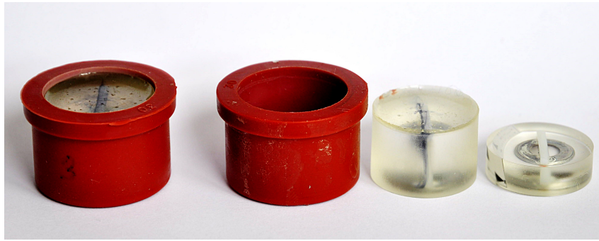
Abbildung 4.1: Verschiedene Stadien von Schliifproben
