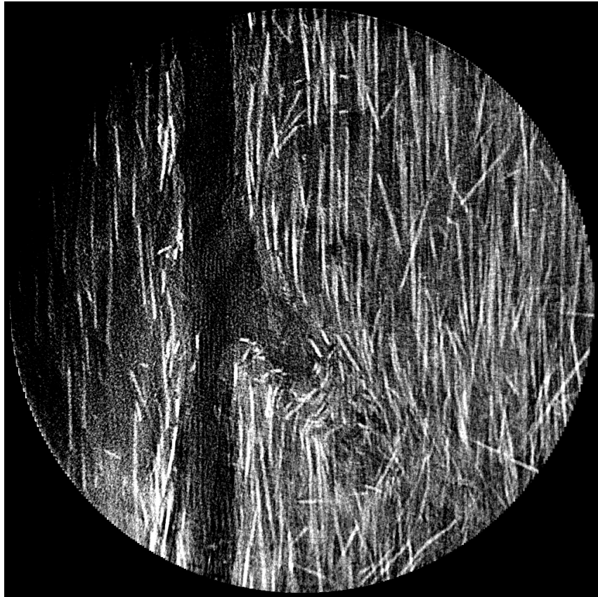
Abbildung 4.9: Schnittbild PA6GF30 mit Orientierungsmarkierung
