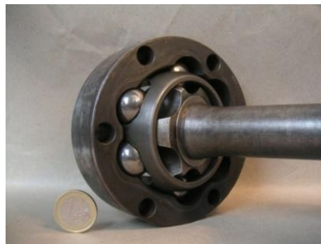
Bild 4.17: Gleichlaufgelenk eines Autos
